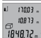
По окончании третьего измерения объем автоматически рассчитывается и высвечивается в строке результата b. Отдельные измеренные значения отображаются в строках измеренных значений a.
