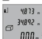
После этого измерьте длину, ширину и высоту друг за другом как при измерении длин. Между тремя измерениями лазерный луч остается включенным.
