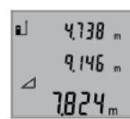
Після закінчення останнього вимірювання результат для вимірюваного відрізка «X» з'являється в рядку результату b. Okремі значення вимірювання з'являються в рядках для вимірюваних значень a.
