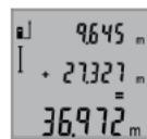
Для опрашивания суммы двух измерений нажмите еще раз кнопку «плюс» 8. Расчет суммы отображается в строках измеренных значений **a**, сумма отображается в строке результата **b**.
