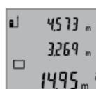
По окончании второго измерения значение площади автоматически рассчитывается и высвечивается в строке результата b. Отдельные измеренные значения отображаются в строках измеренных значений a.
