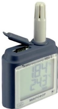
Рис.15. Термогигрометр ИВА-6Н с картой памяти.
