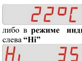
Переключение между режимами текущей температуры и максимальной температуры производится кнопкой «M» (нажать и удерживать до смены режима, повторно нажимать через 1 сек.).
