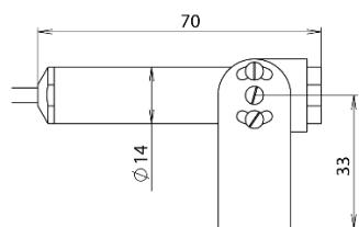
Миниатюрный бесконтактный датчик температуры
