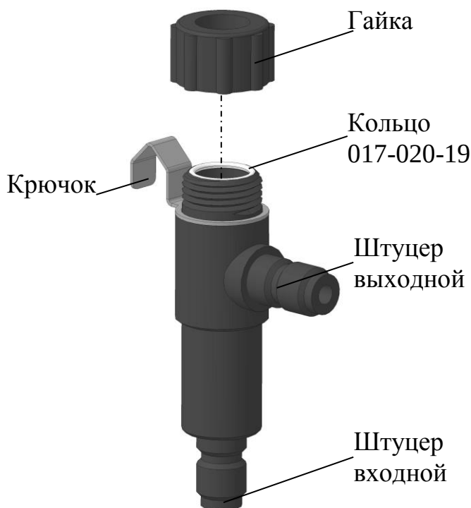
Рисунок 2.5 – Кювета проточная ВР41.15.310
