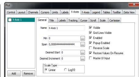
Если автоматический "скролл" оси X не требуется, снимите галочку на вкладке X-Axes > Tracking > "Enable".
