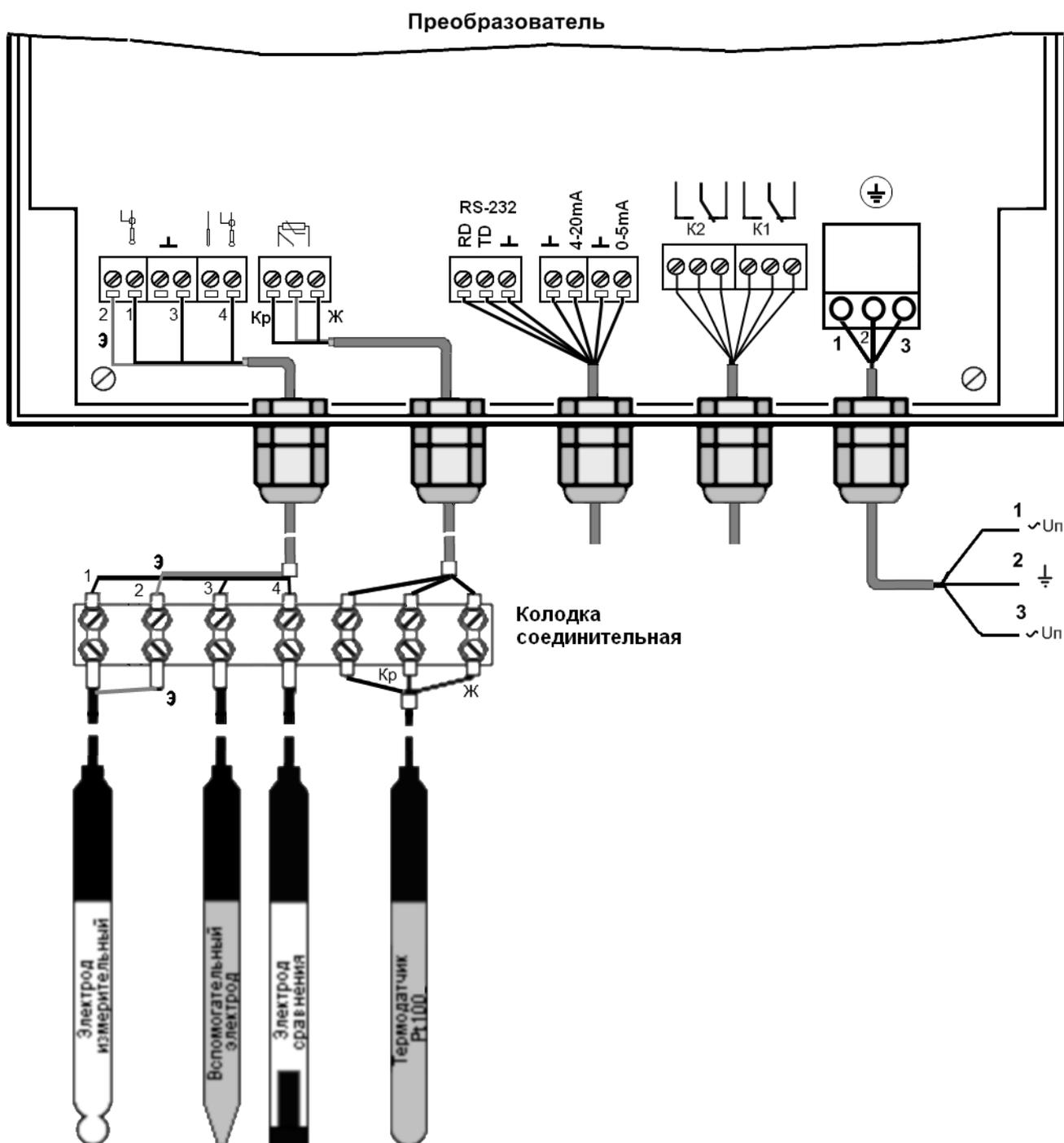
Рисунок А.2 – Дифференциальная схема включения
