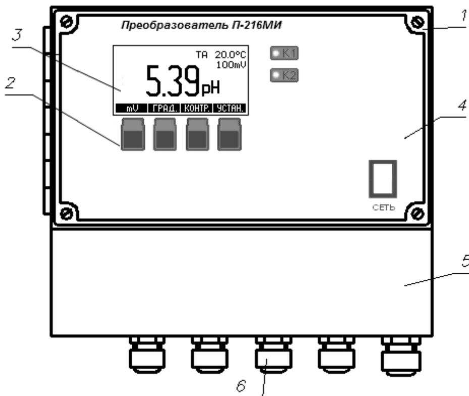
1. Корпус. 2. Панель управления. 3. Цифровое табло. 4. Прозрачная защитная крышка.
