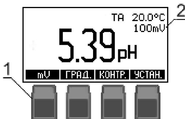
Рисунок 3 – Панель управления(1) и табло (2)
