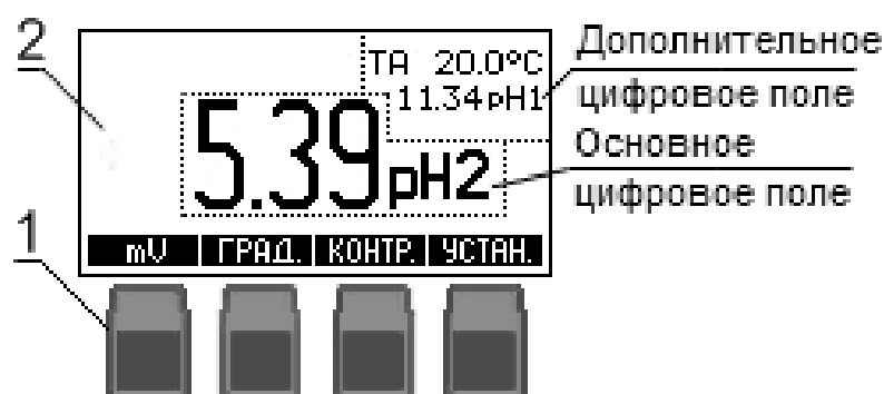
Рисунок 3 – Панель управления(1) и табло (2)
