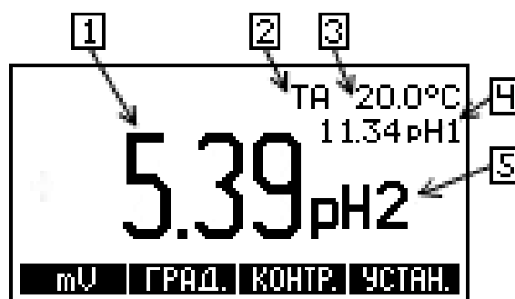
Рисунок 6 - Пример отображения информации на табло в режиме измерения рН
