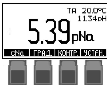
Рисунок 3 – Цифровое табло и панель управления
