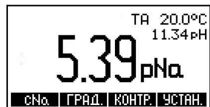
В меню установок параметров кнопками ▲ и ▼ нужно выбрать «**УСТАНОВКА ПРЕДЕЛА рNa**». При этом на табло выводится значение предела срабатывания сигнализации установленное ранее. Нажать кнопку **РЕДАК.**
