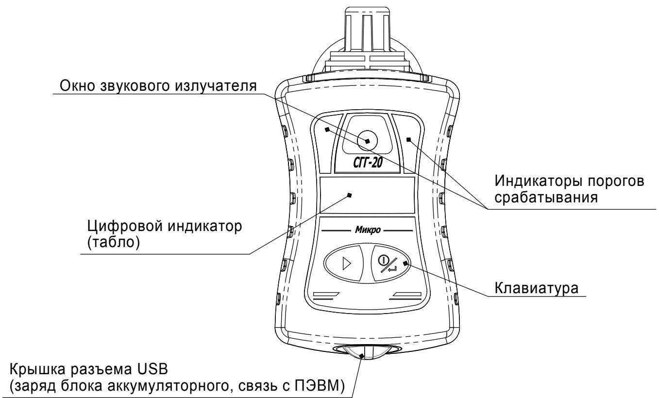
Рисунок 1.2 – Органы управления и индикации сигнализаторов
