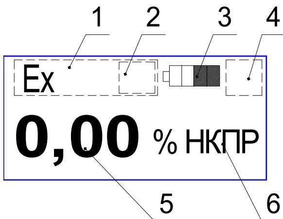
Рисунок 1.5 – Вид табло сигнализаторов в режиме ИЗМЕРЕНИЯ
