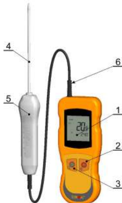
Рис. 1 Основные части прибора ТК-5.01С, органы управления
