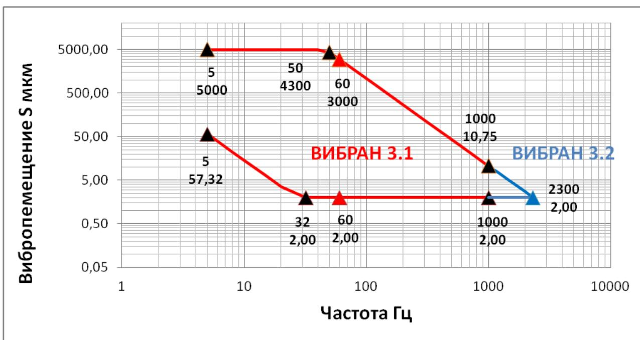
Рисунок А.3 – Диапазон измеряемых значений вибропомещения (мкм) для чувствительности вибропреобразователя 10 мВ/м/с<sup>2</sup> (100 мВ/g) в полосе частот 5 Гц – 10000 Гц
