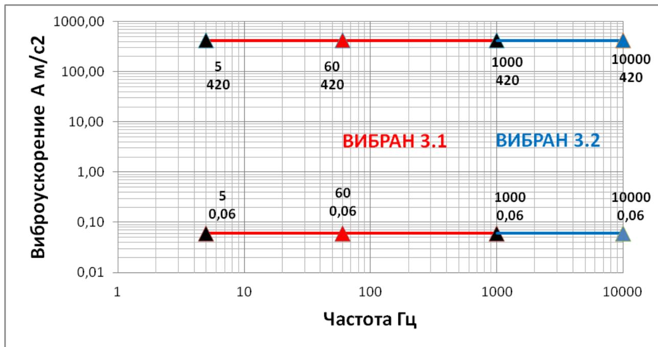
Рисунок А.1 – Диапазон измеряемых значений виброускорения ( $\text{м/с}^2$ ) для чувствительности вибропреобразователя 10 мВ/м/с<sup>2</sup> (100 мВ/g) в полосе частот 5 Гц – 10000 Гц
